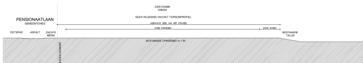
Figuur 7: Terreinsnede van de tijdelijke parking bovenop de ophoging. (Bron: BINST ARCHITECTS NV, 2018).
