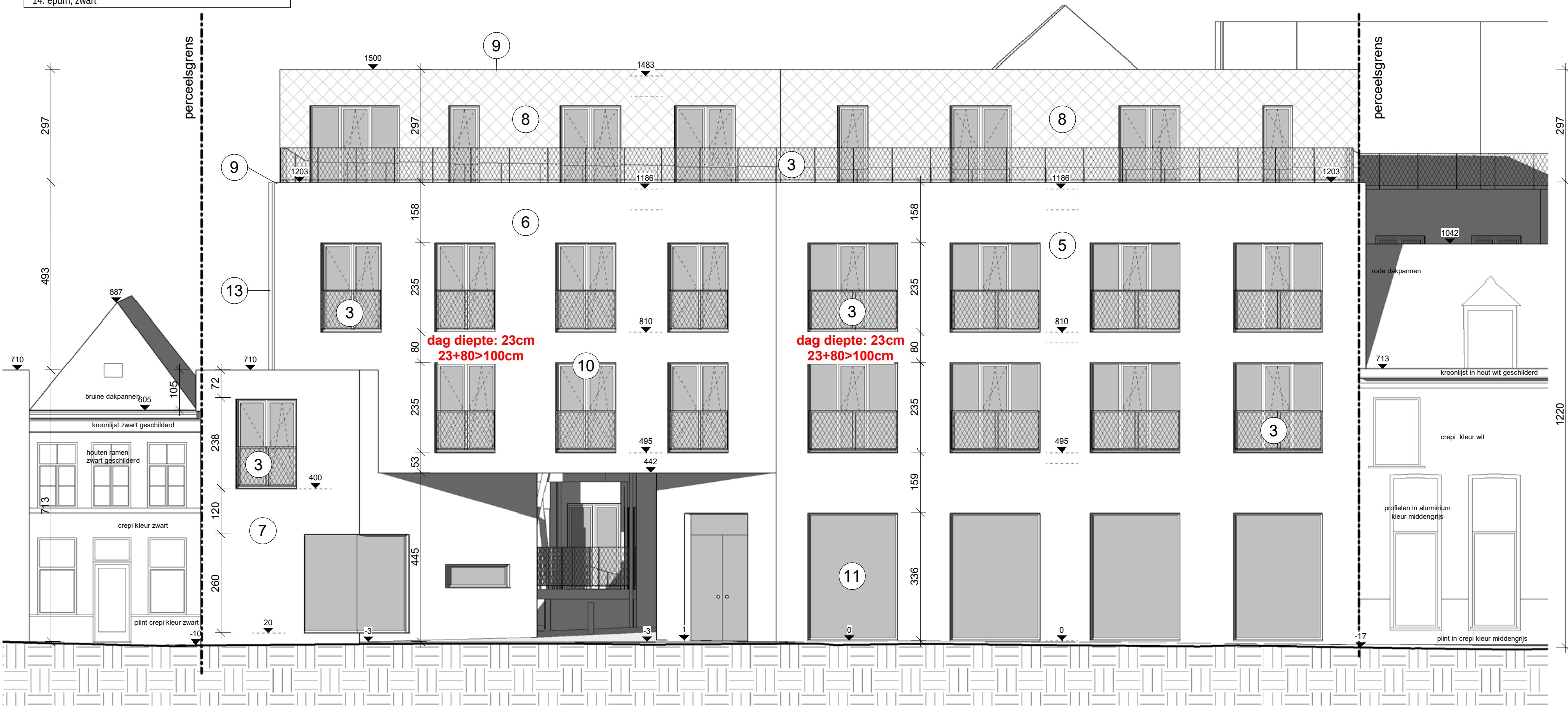
1 Vooraanzicht Blok A (Lekkerbeetstraat) - Nieuwe Toestand 1 : 100
