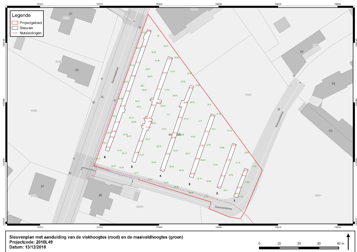
Figuur 8: Sleuvenplan met weergave van de vlakhoogtes (rood) en maaiveldhoogtes (groen) op de GRB-basiskaart (Bron: Geopunt).
