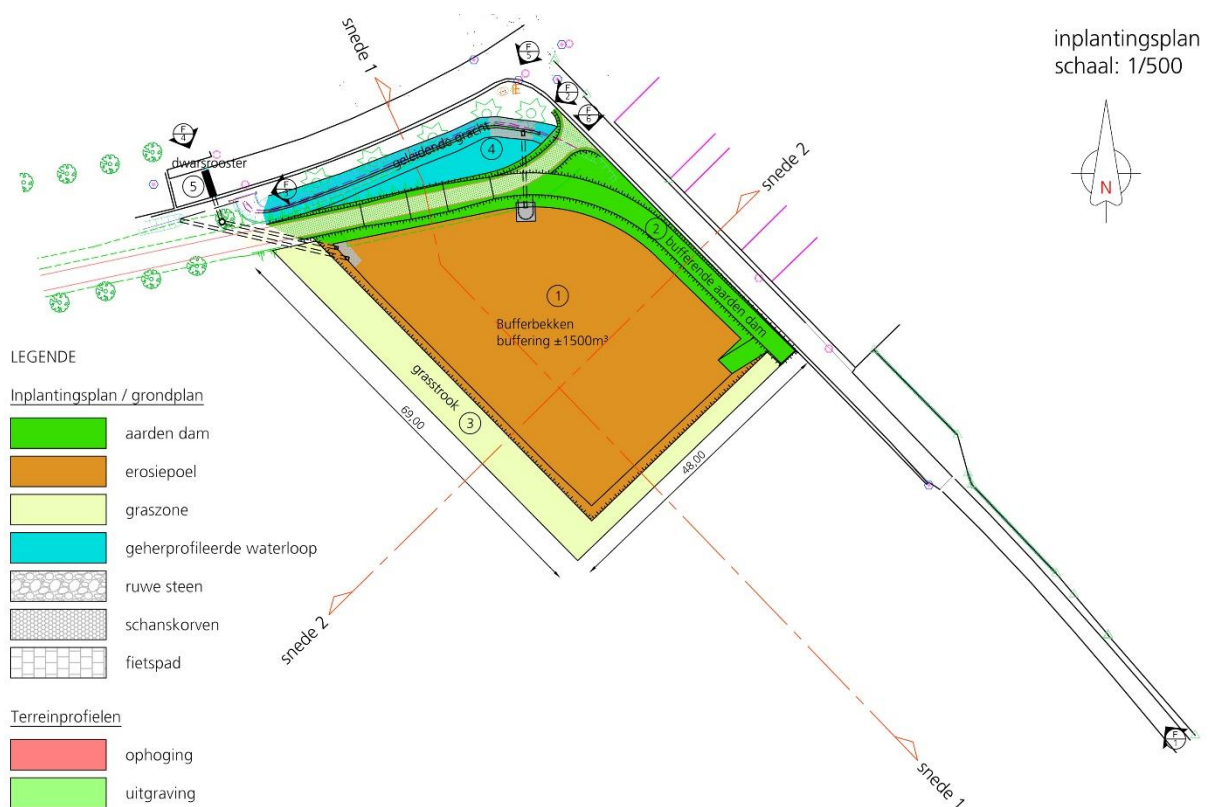
Figuur 20: Bufferbekken Kuntich - Tassinstraat: inrichtingsplan van de geplande bodemingrepen (bron: VLM).
