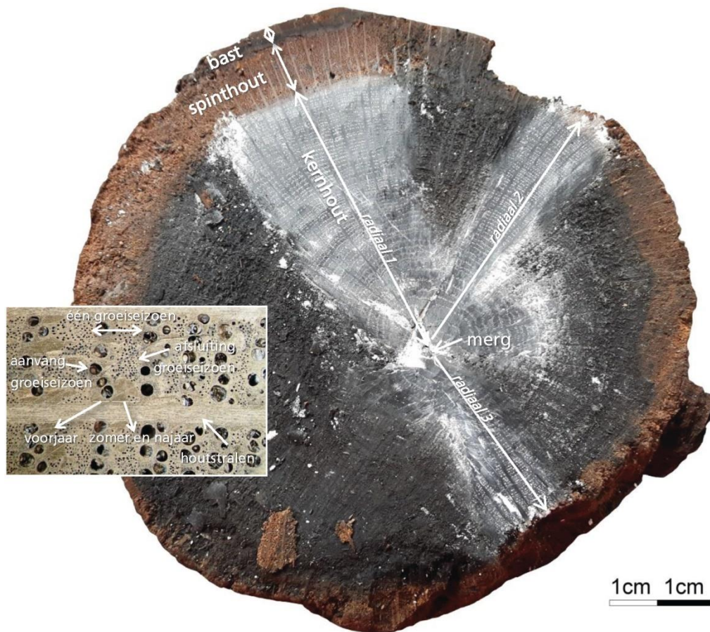
Afb. 1 Dwarsdoorsnede van een monster van eik uit archeologische context. Het monster is langs drie radialen geprepareerd met een dubbelzijdig scheermesje, zodat de celstructuur zichtbaar wordt. De vaten zijn met krijtpoeder ingewreven. Het donkere kernhout onderscheidt zich van het lichtere spinhout. De spinhoutzone faciliteert het transport van water en voeding van de boom en onderscheidt zich van het kernhout door de lichtere kleur en het ontbreken van de tylose in de vaten. Aan de buitenzijde zijn resten van de bast waar te nemen. De laatste spinhoutring onder de bast wordt ook wel de wankant genoemd. De uitsnede toont een microscopische opname van enkele jaarringen.
