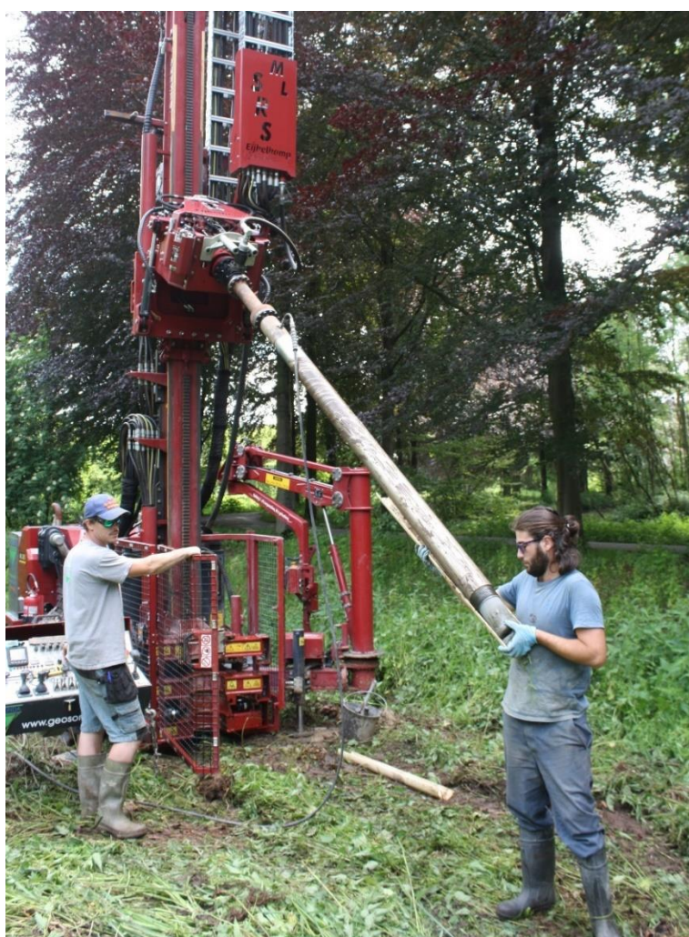
Figuur 11: Fotografische opname van de uitgevoerde mechanische boringen met zicht op de liners.
