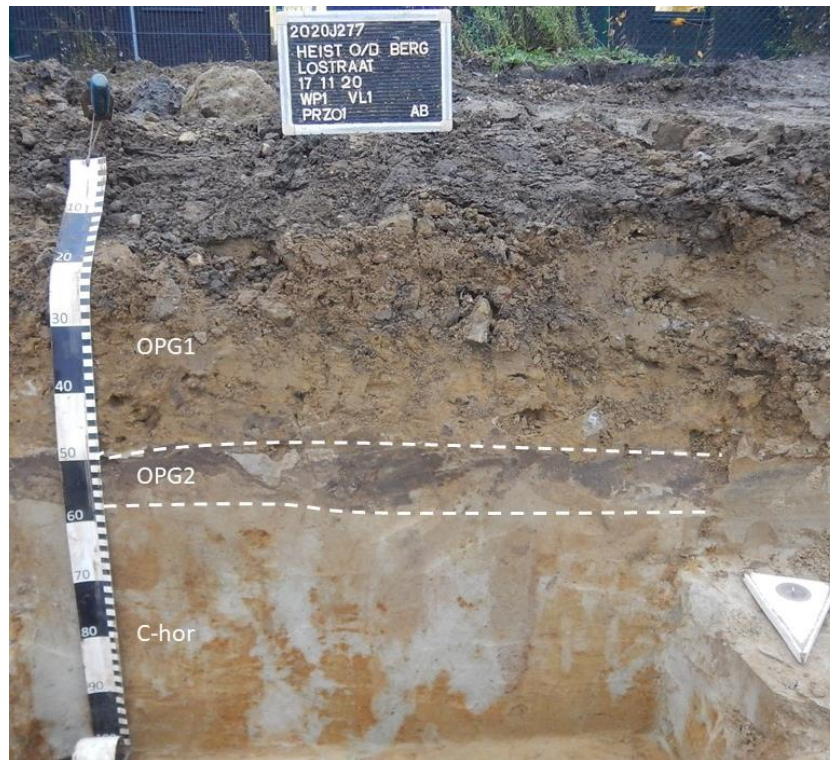
Figuur 15: Profiel ZO2 AB in werkput 1
