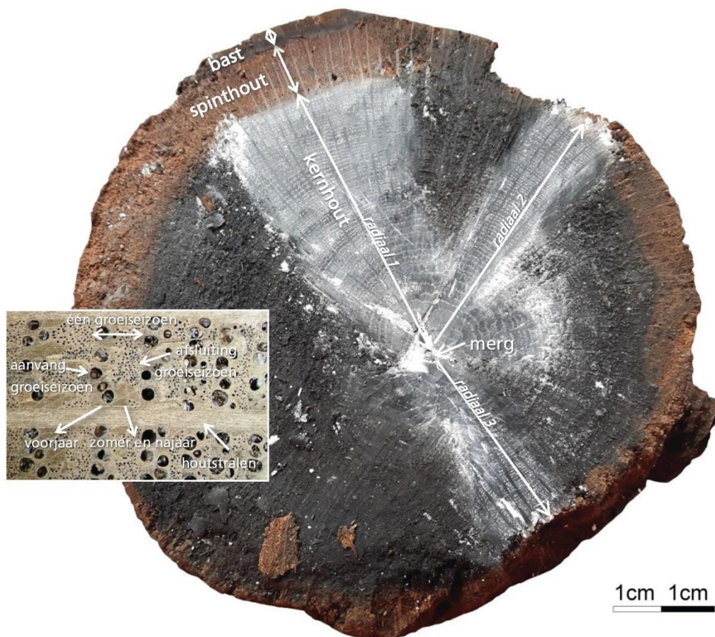
Afb. 1 Dwarsdoorsnede van een eikenstam met drie geprepareerde radialen. De vaten zijn met krijtpoeder ingewreven. Het donkere kernhout onderscheidt zich van het lichtere spinthout. De spinthoutzone faciliteert het transport van water en voeding van de boom en onderscheidt zich van het kernhout door de lichtere kleur en het ontbreken van de tylose in de vaten. Aan de buitenzijde zijn resten van de bast waar te nemen. De laatste spinthoutring onder de bast wordt ook wel de wankant genoemd. De uitsnede toont een microscopische opname van enkele jaarringen.
