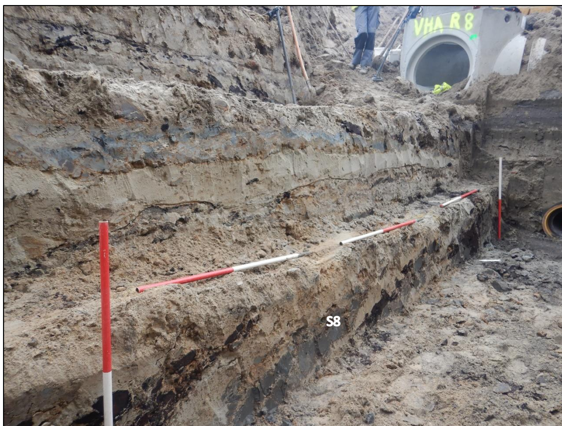
Figuur 32: profiel 8 nabij de Langestraat toont de sterk zandige opbouw van de diepe grondlagen S8
