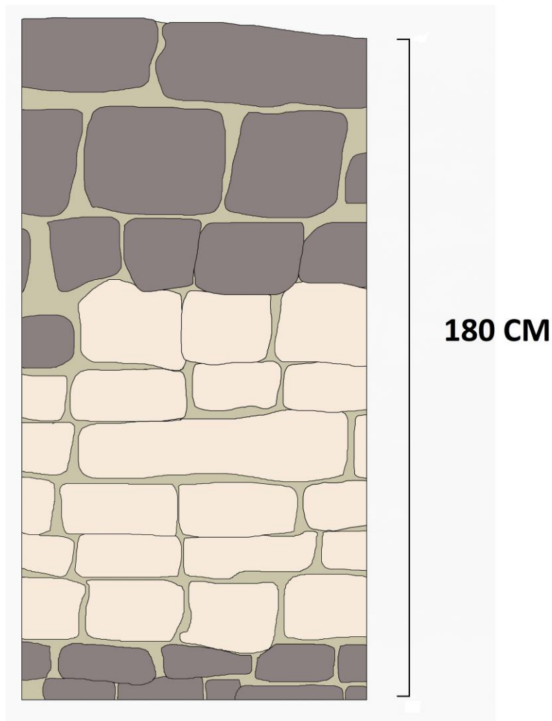
Figuur 53: Tekening van muur 1. Wit/beige = Gobertangesteent. Grijs/bruin = Tiens kwartsiet (© ARCHEBO bvba, 2018).
