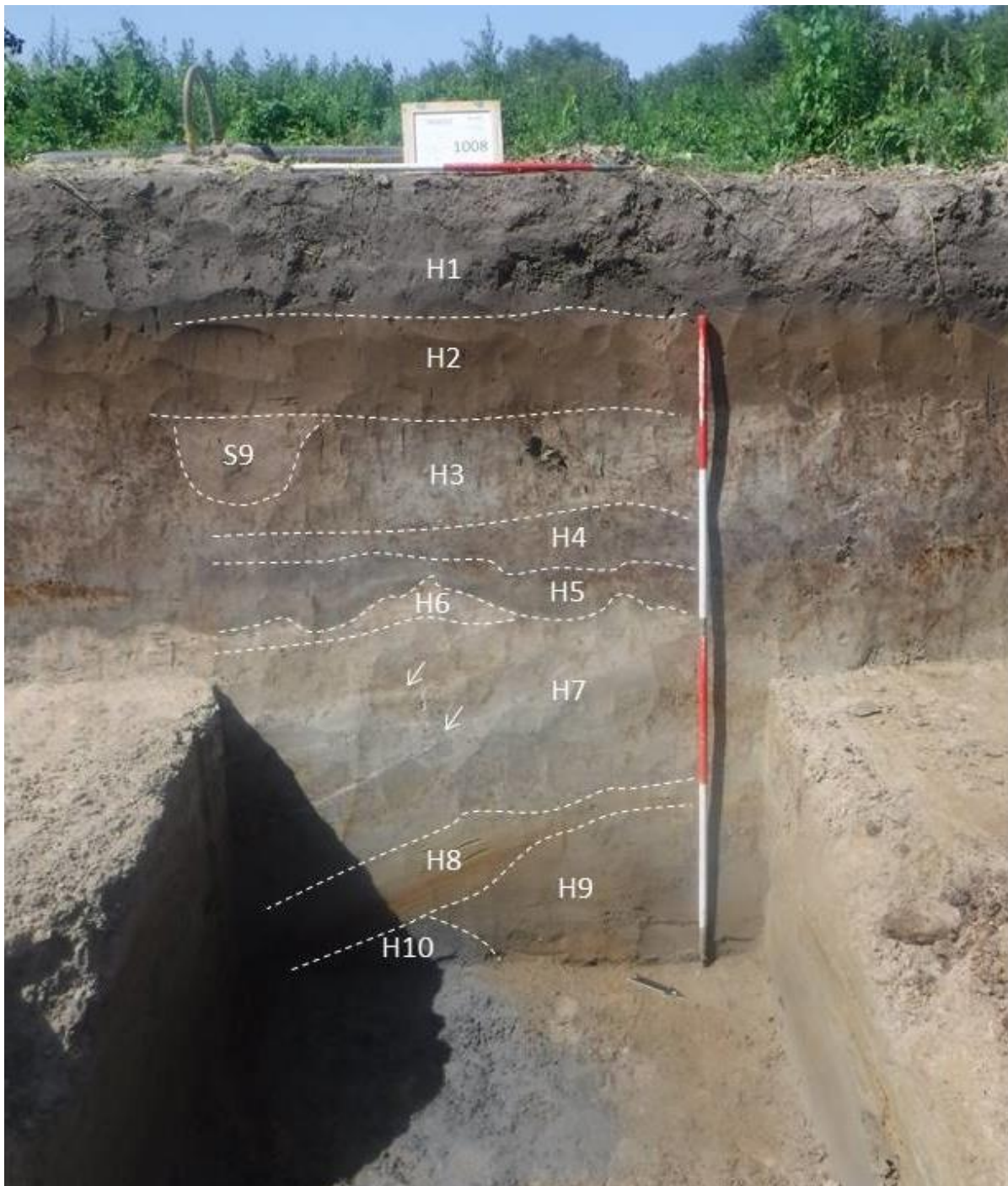
Figuur 25: Referentieprofiel P101, met aanduiding van de besproken horizonten.
