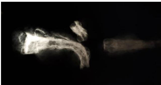
Figuur 114 Röntgenopname van V155, geplooid nagel, lengte 28mm, diameter kop 9mm.
