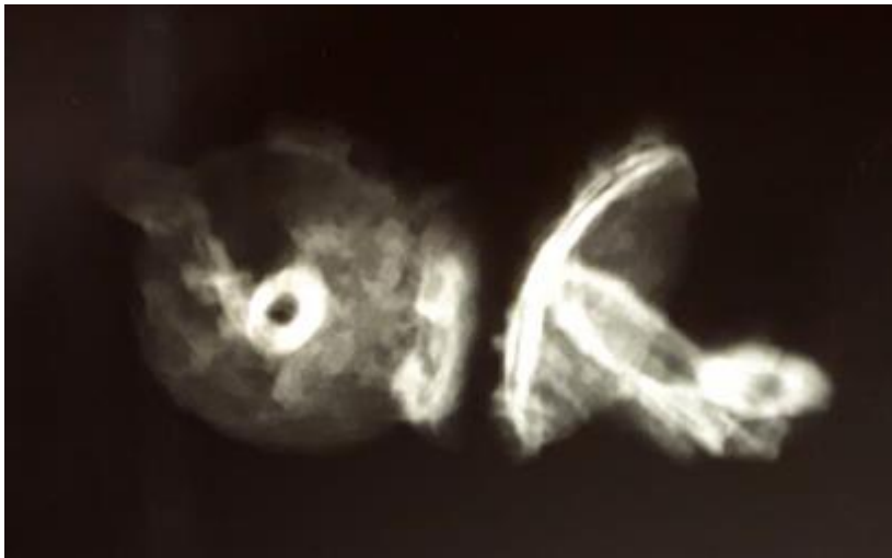
Figuur 86 Röntgenopname van V204, twee spijkers, diameter kop 13mm.
