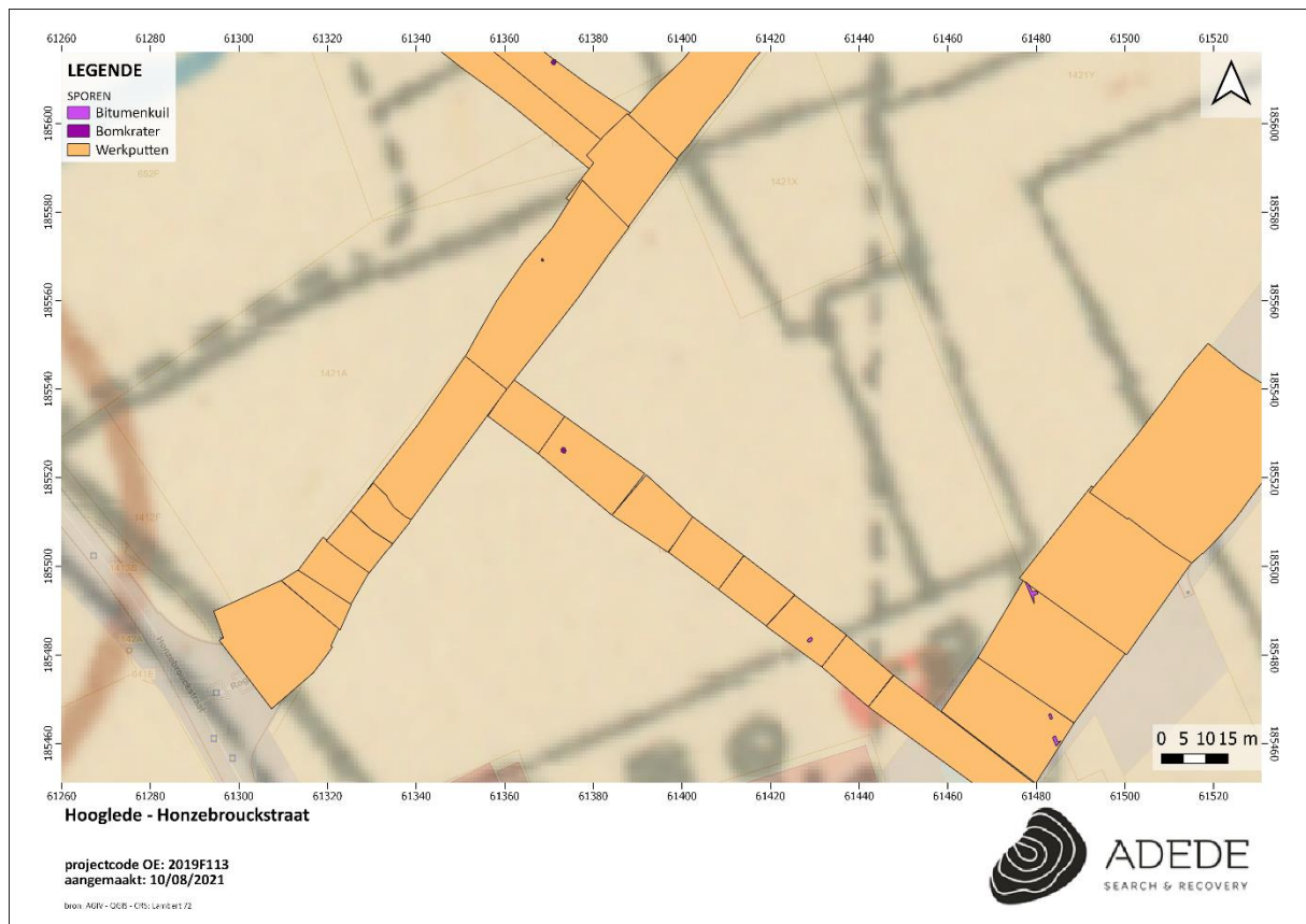
Figuur 71: Bitumenkuilen en bomkraters aangetroffen tijdens het onderzoek, geplot op trenchmap
