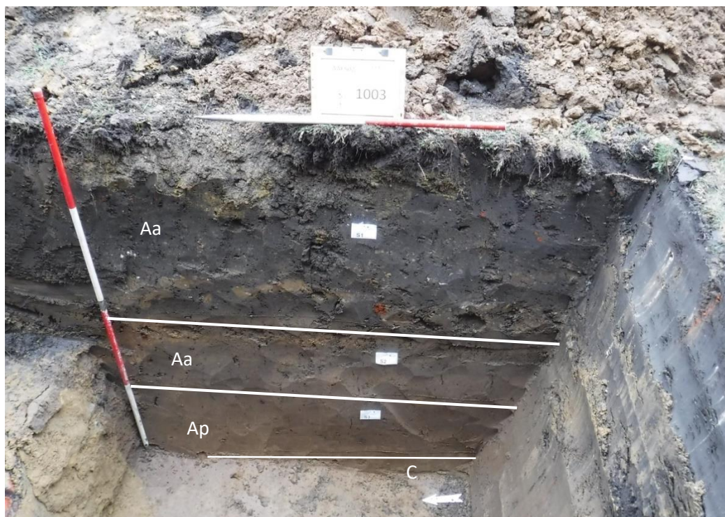
Figuur 11: Bodemprofiel in werkput 2 met aanduiding van de aanwezige bodemhorizonten
