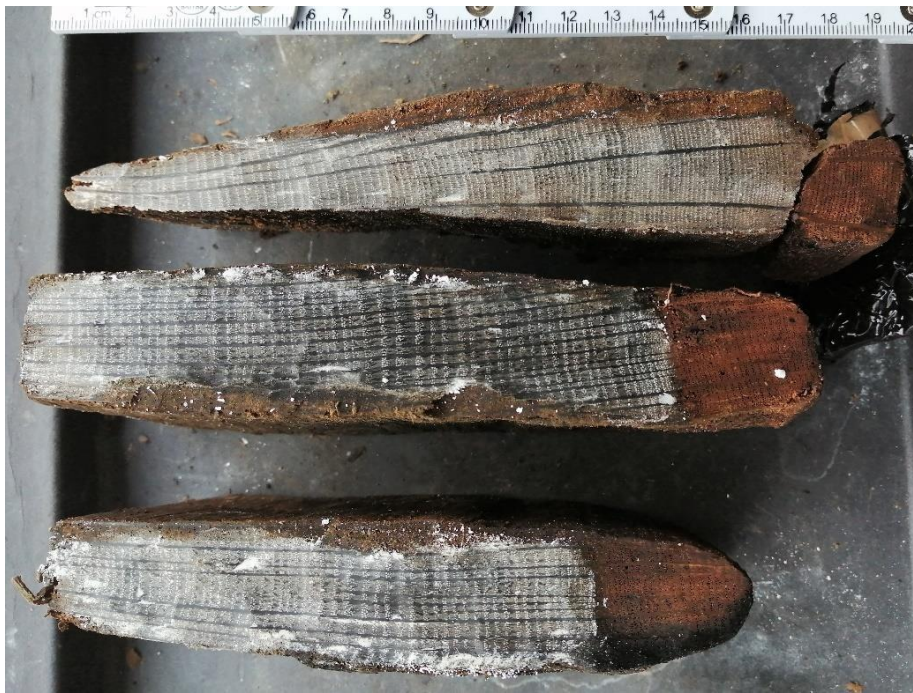
Afb. 1 Geprepareerde houtmonsters gezien op de dwarsdoorsnede van het hout. Van boven naar beneden 130-24, 130-7 en 130-9 uit waterput S87.
