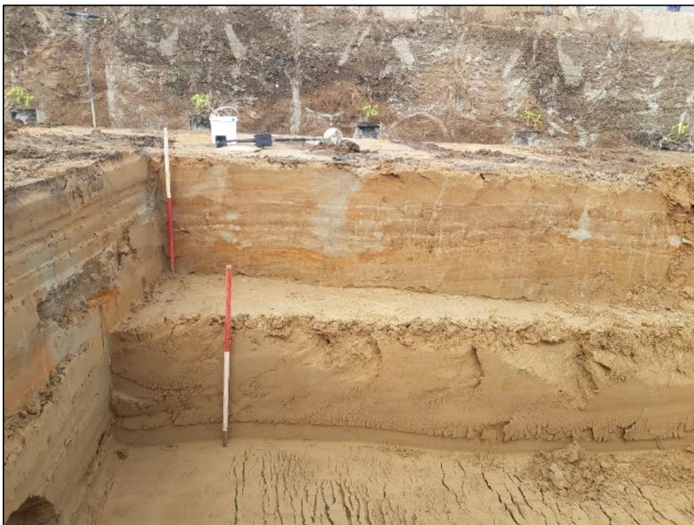
Figuur 12: Profiel in werkput 1. De overgang naar de moederbodem is bovenaan nog zichtbaar. Bovenkant werkput is +4,65m TAW. Onderaan de gelaagdheid in de moederbodem.
