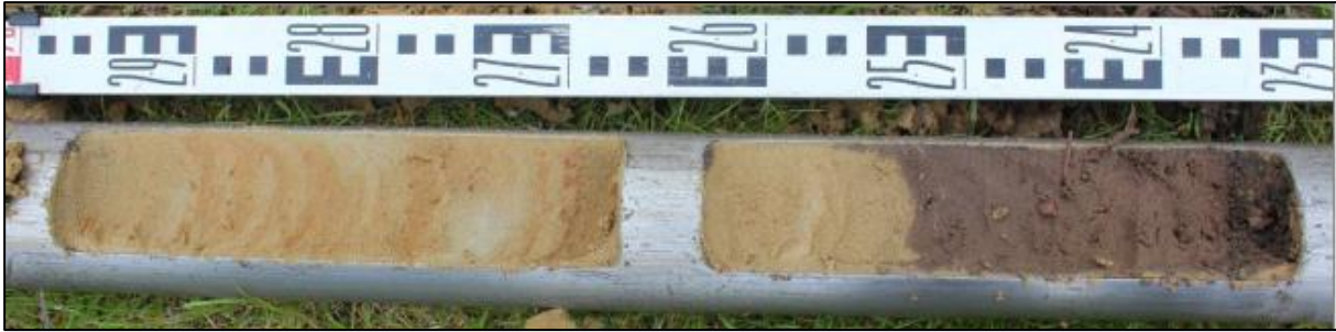
Figuur 11: Illustratie van de scherpe grens tussen de gedefinieerde eenheid 2 en 3. 26
