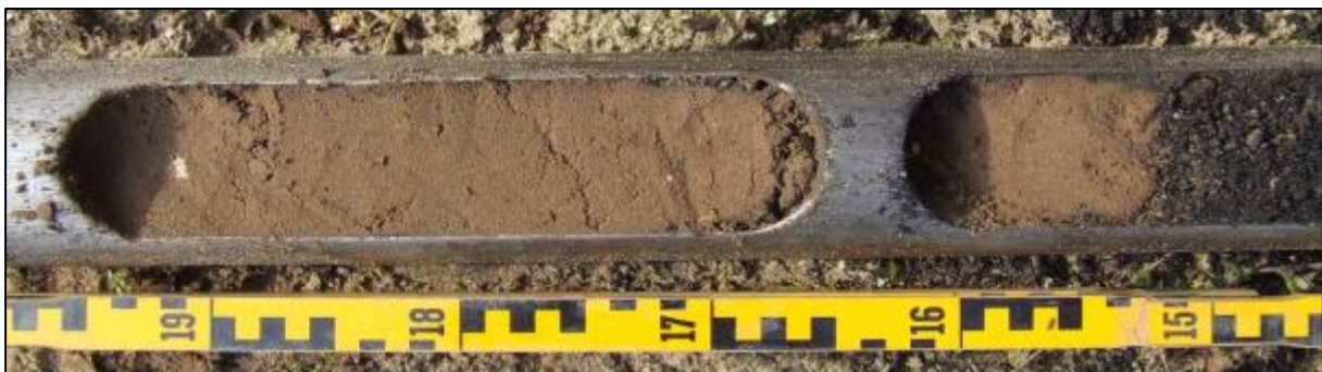
Figuur 10: De duidelijk te onderscheiden homogene bruine laag (eenheid 2) en een scherpe grens met de puinhoudende lagen van eenheid 1. 25
