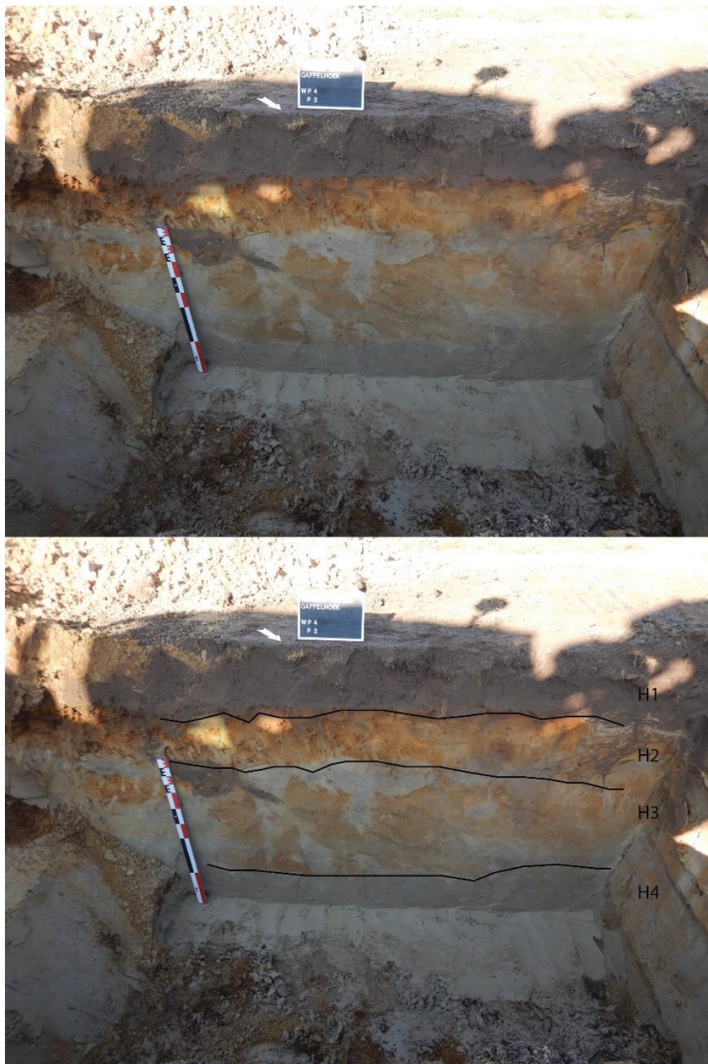
Figuur 44: Afbeelding met schematische weergave van bodemhorizonten in profiel P2.
