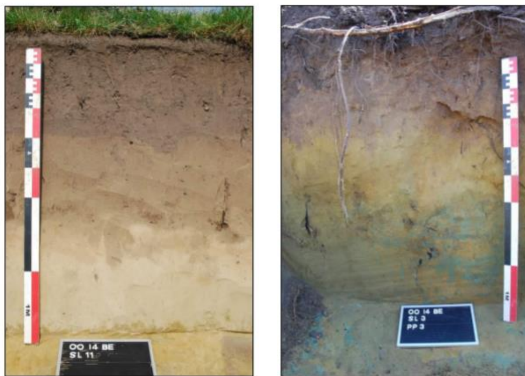
Figuur 49: Profiel met een dubbele plaggenbodem op het Quartaire zand en een profiel met dunne antropogene humus A-horizont. Hieronder bevindt zich dekzand en de Tertiaire Formatie van Diest. 62 (© Aron bvba)
