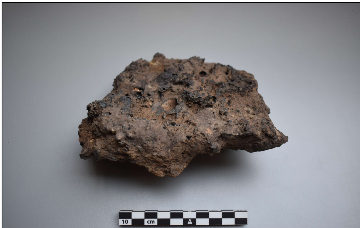
Afb. 85: V25 uit laag S55: een planoconvexe smeedslak.
