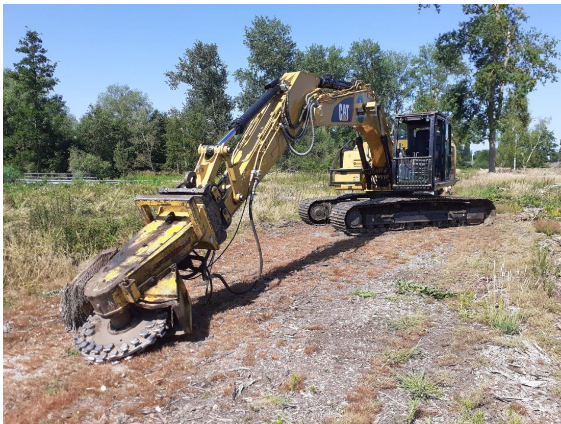
Figuur 5: lange-arm-frees, gebruikt voor de populierenstronken bij de Loopgracht (foto Stad Gent)
