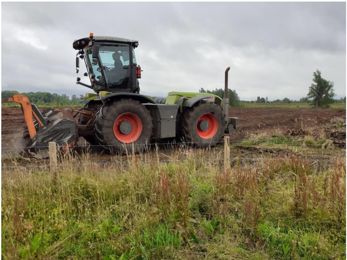
Figuur 9: bosfrees voor het bovengronds verhakselen van het resthout (foto Stad Gent)
