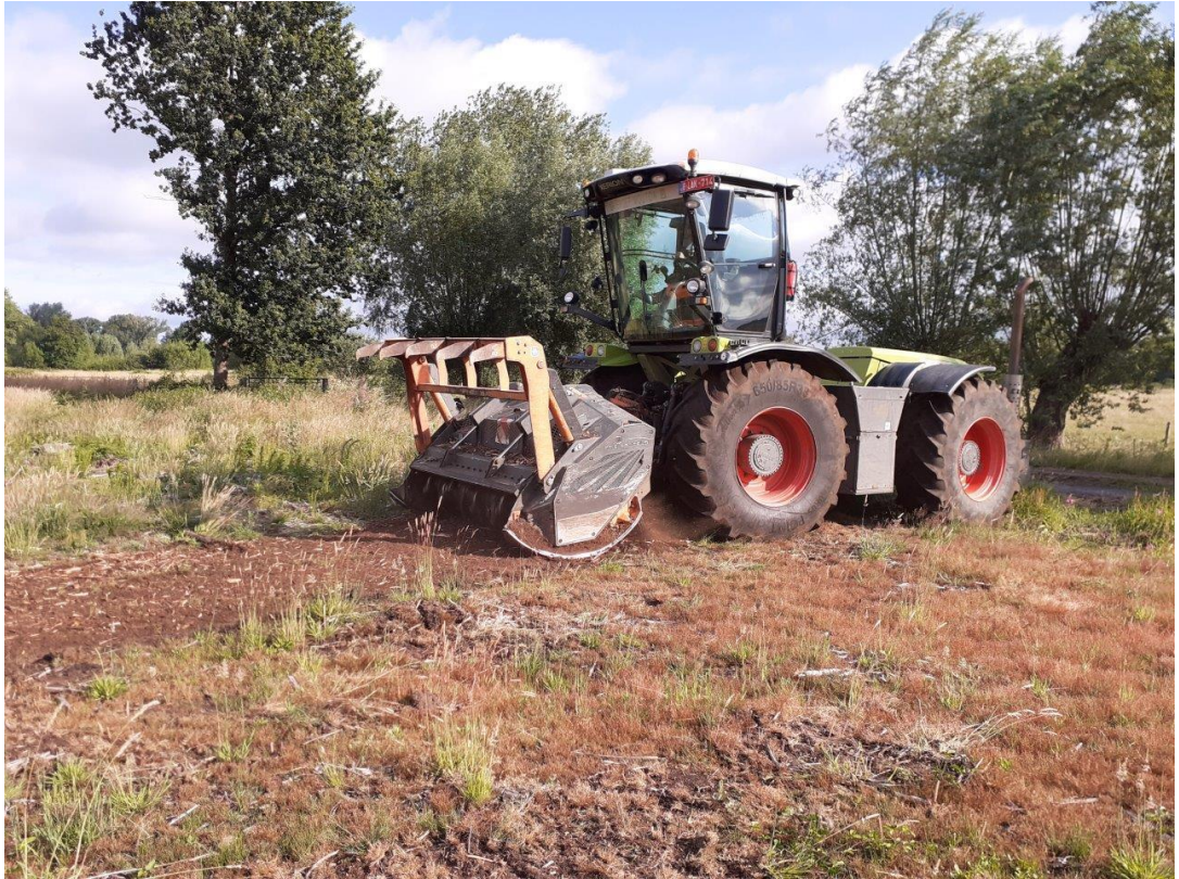
Figuur 8: bosfrees voor het bovengronds verhakselen van het resthout (foto Stad Gent)
