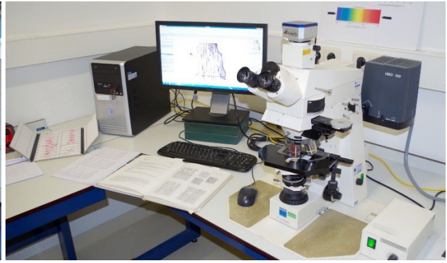
Werkrimte waar de dunne doorsnedes worden voorbereid en geobserveerd met een transmissie microscoop © werkfoto, A.Weitz, 2011.
