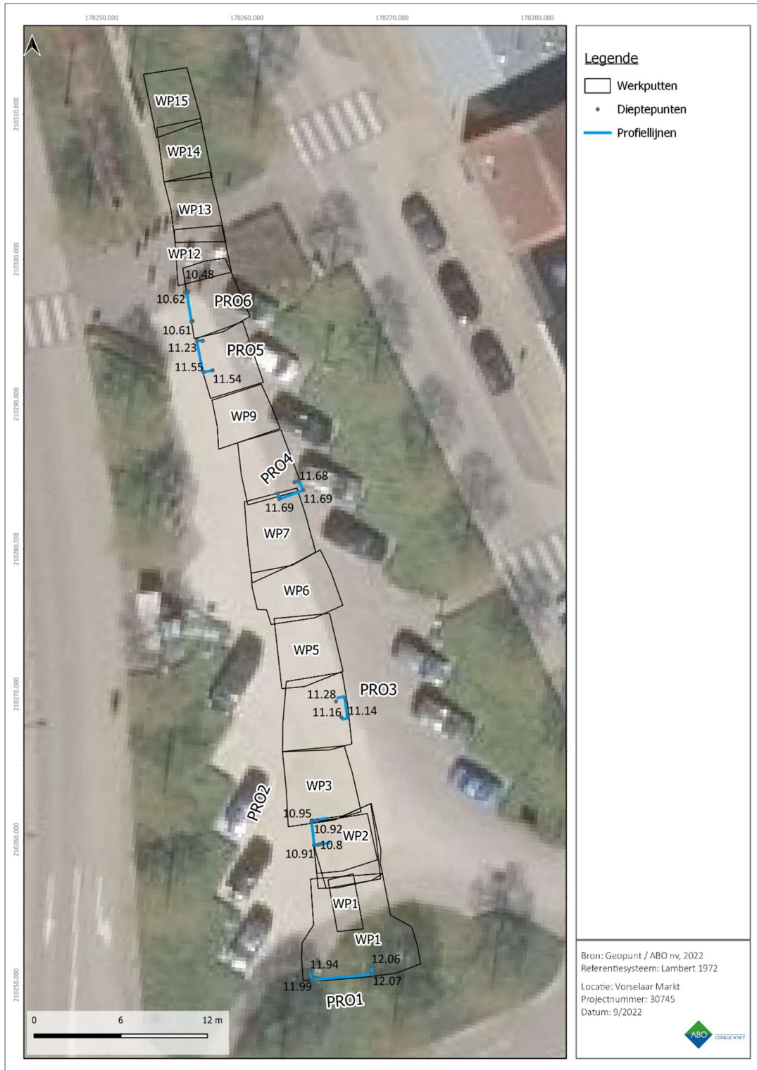
Figuur 25: Werkputten met aanduiding profielen en TAW-waarden onderaan ingemeten
