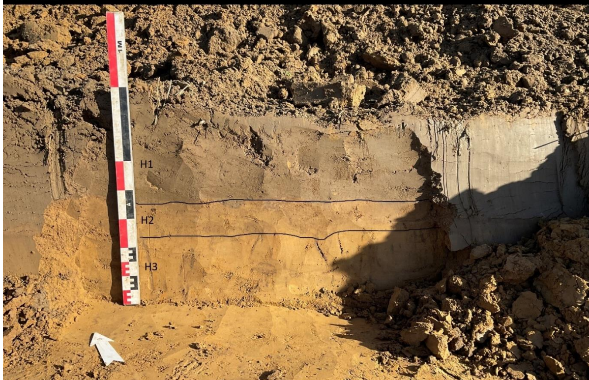
Figuur 20: putwandprofiel P2
