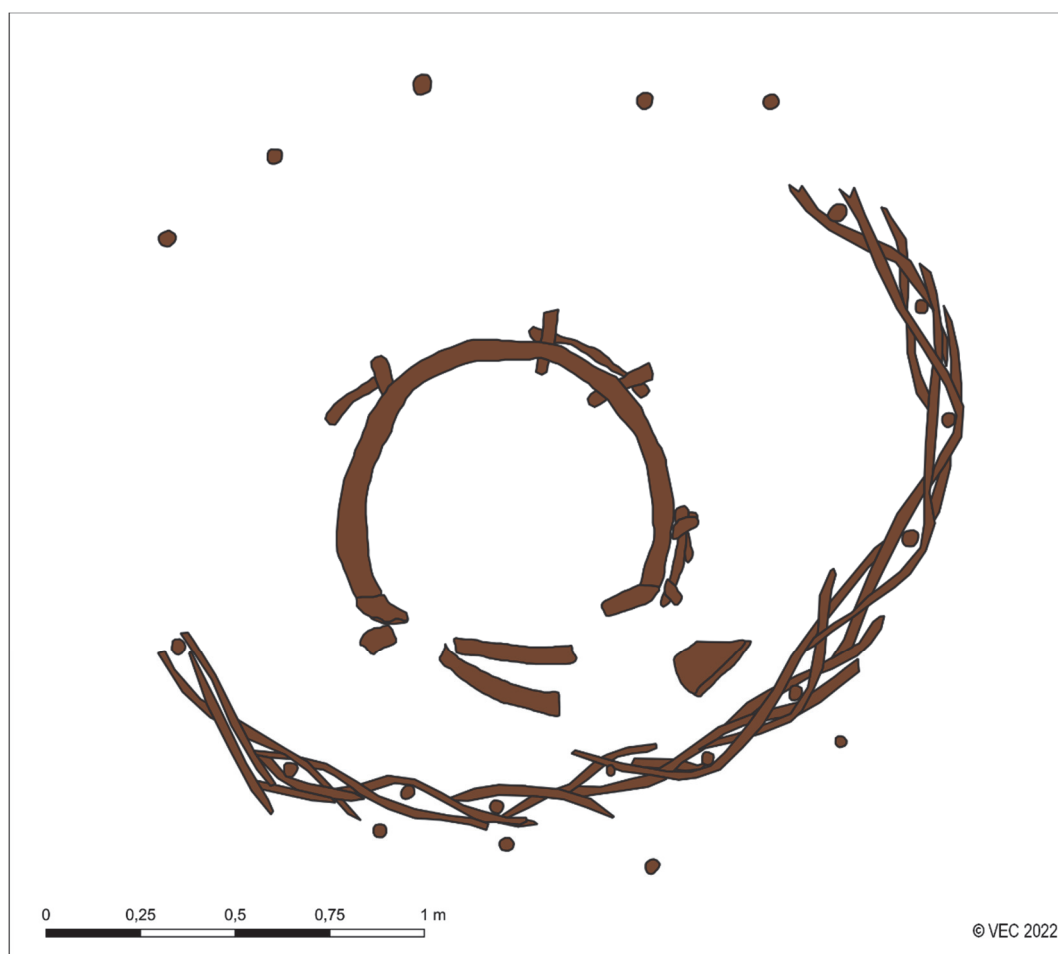
Afb. 52. Veldtekening van de houten constructie van waterput S 11.8 in vlak 3 (schaal 1:10).
