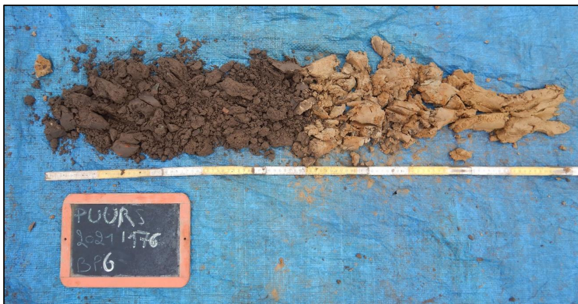
Figuur 6 Boorkolom van BP6 met een A-C profiel in het westelijk deel van het plangebied.
