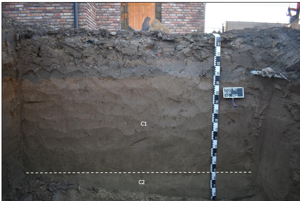
Afb. 20: Proefput 2: profiel 2 met 30 cm verstoringen bovenop de brabantleem bestaande uit 'rode' kalkloze leem tot -190 cm (C1) en de 'gele' kalkrijke leem (C2).
