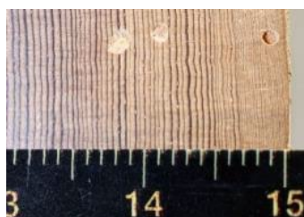
Fig. 14. Detail van het einde van de groei van een monster met zeer traag groeitempo: 2 tot 3 mm hout omvat meer dan 30 ringen (P482/01/001). © KIK-IRPA, Brussel, werkfoto
