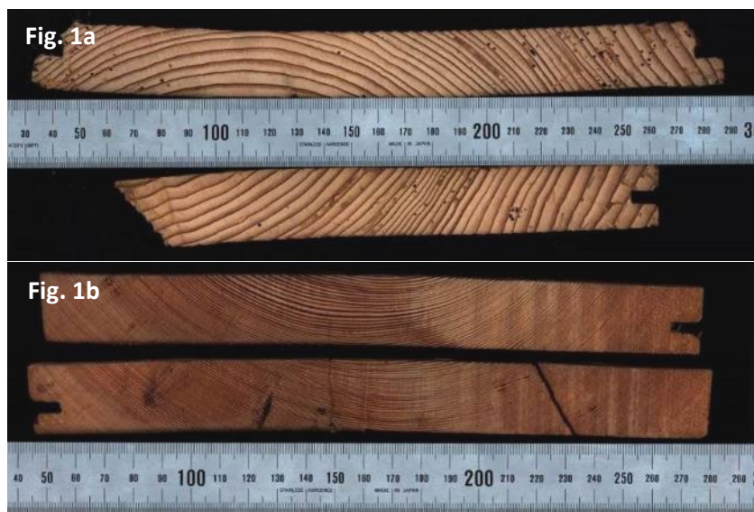
Fig. 1. Voorbeelden van de smalle zijden van planken in grove den met verschillende groeiritmen: snel ritme (brede ringen) in Fig. 1a en zeer traag ritme (zeer smalle ringen). Fig. 1b (schaal met verdeling in halve millimeters). © KIK-IRPA, Brussel, werkfoto
