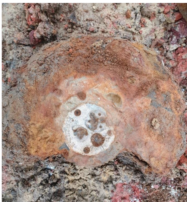
Figuur 38: Bodemontsteker, type Lg Bd. Z 10.
