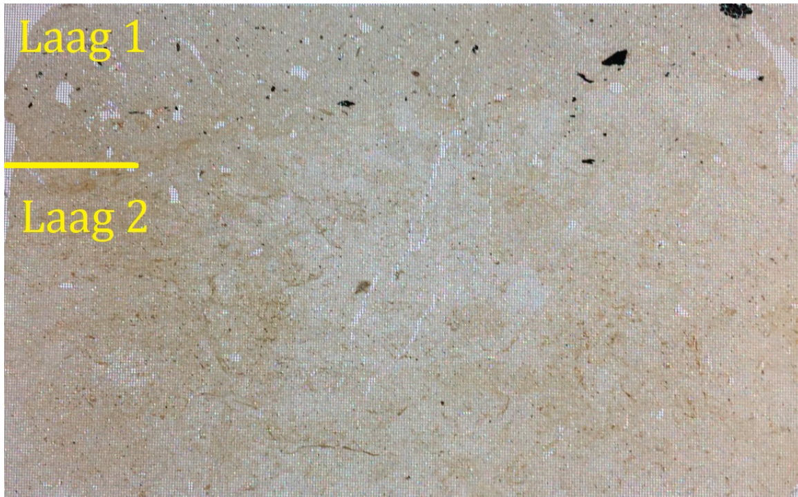
Afb. 1. Slijpplaat S39. In geel de in dit onderzoek onderscheiden lagen.
