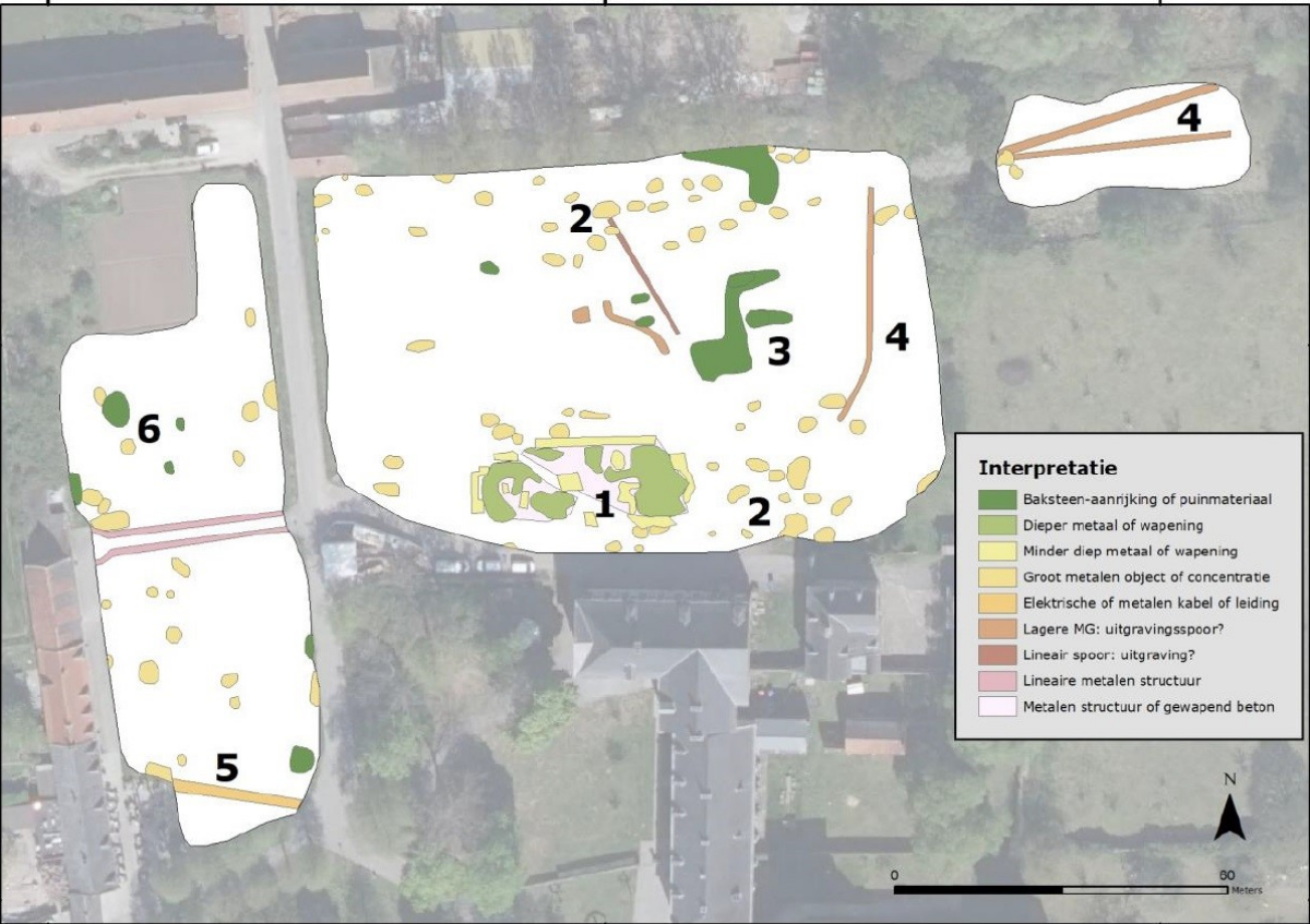
Afb. 11: Overzicht van de resultaten van het EMI onderzoek (3dSoil).
