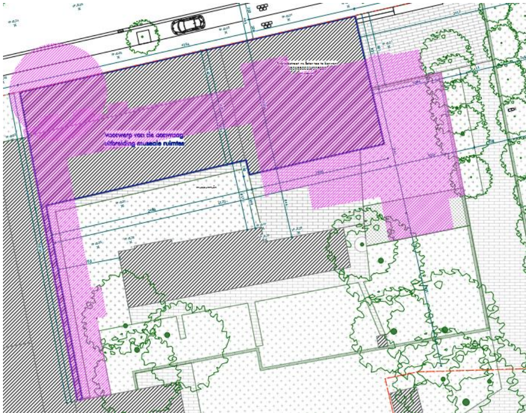
Figuur 4: Uitsnede bouwplan met aanduiding van te slopen bebouwing en een te kappen boom (roze) en de nieuwe toestand (gearceerd met blauwe omkadering). Plan aangeleverd door de initiatiefnemer.
