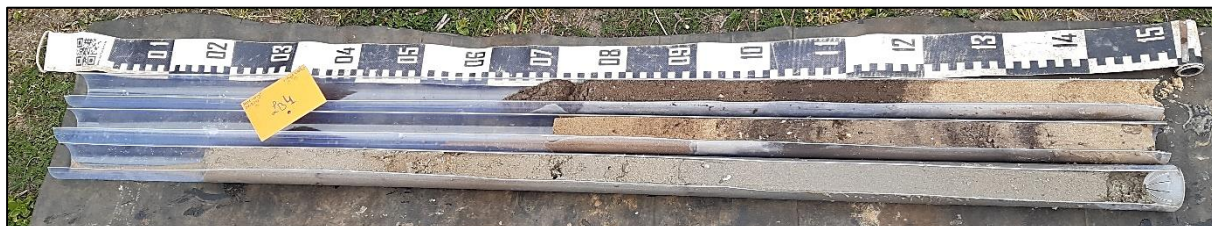
Figuur 16: Boring 4 van 0 (linksboven) tot 4 m (rechtsonder) onder het maaiveld. De eerste liner bevat 1 m sediment, de volgende twee telkens 1,5 m.
