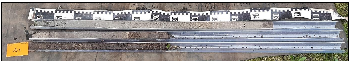
Figuur 13: Boring 1 van 0 (rechtsonder) tot 4 m (linksboven) onder het maaiveld.
