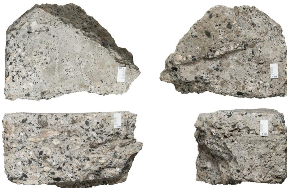
Figuur 44: betonfragment v6.1 met het geëffende bovenzvlak (links boven), het onregelmatige ondervlak (rechts boven), het breukvlak (links onder) en het rechte zijvlak dat tegen de muur was aangegoten (rechts onder) (©Fodio).
