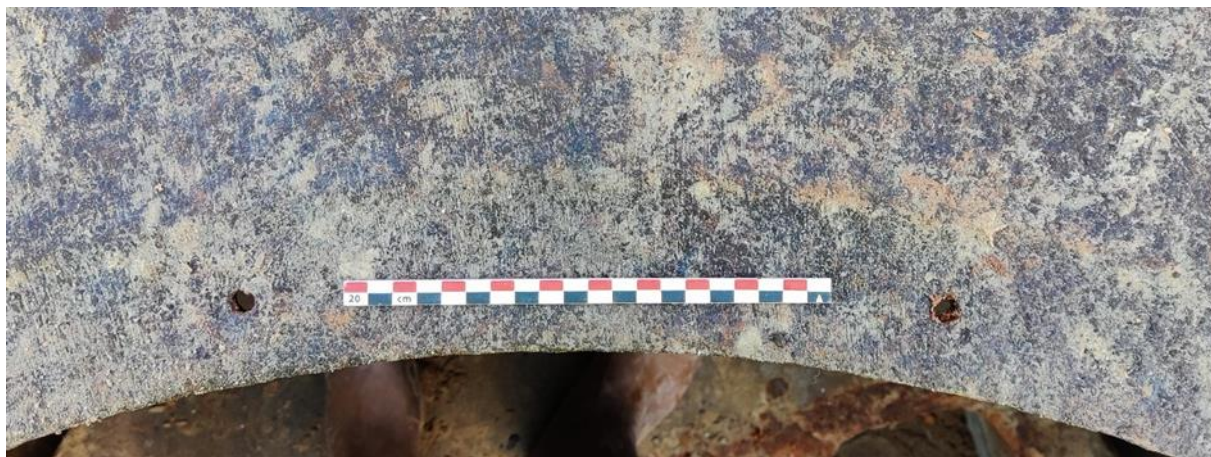
Figuur 29: Detailopname van de dunnere zone met gaten rond de opening voor de koepelbevestiging.
