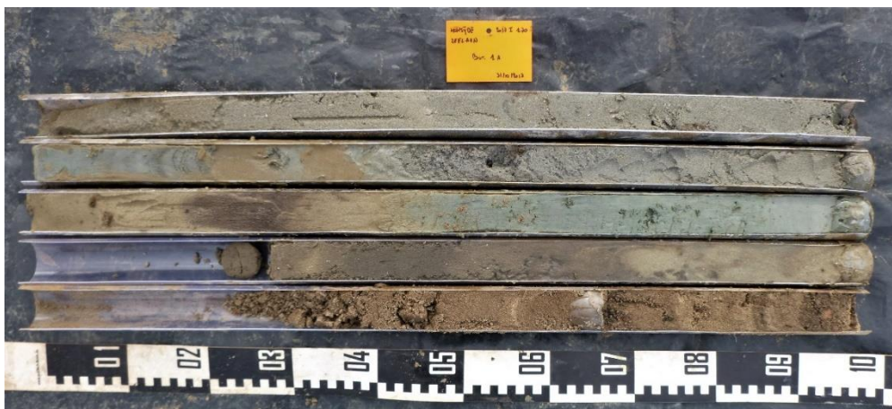
Figuur 5: Mechanische boring 1A, van 0 cm (linksonder) tot 500 cm (rechtsboven). Topmateriaal sterk gecompacteerd
