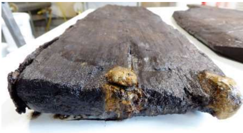
Figuur 40: Aanzicht plank M3 met resten van gecorrodeerd metaal
