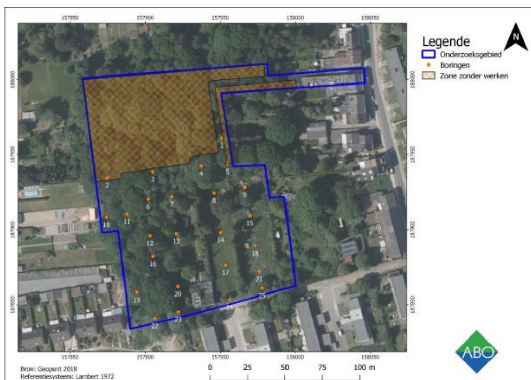
Figuur 6: De uitgevoerde controleboringen door Geosonda nv op het onderzoeksgebied (© ABO nv) (Bron: PELSMAEKERS S., 2019a, p. 21, Figuur 24)
