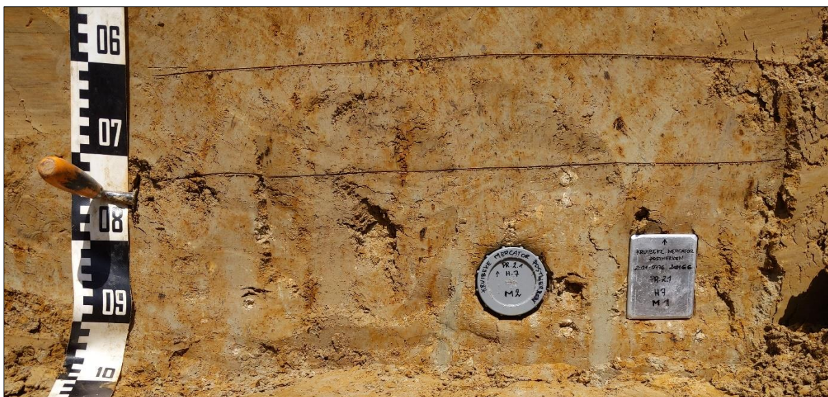
Figuur 6: Voorbeeld monsteropname, referentieprofiel 2.1: OSL-monster (links, rond) en micromorfologisch monster (rechts, vierkant)
