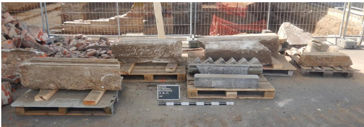
Figuur 81: Werkfoto van de gerecupereerde natuursteenfragmenten uit het opgespoten zand
