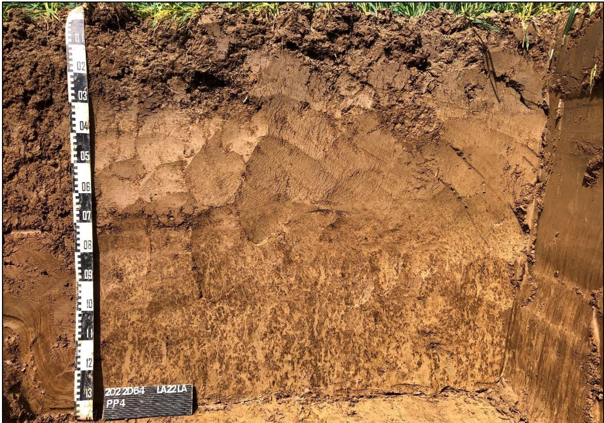
Afb. 25: PR4 met egaal bruine ongerijpte leemrijke toplaag (Lz3: 0-70 cm -mv) met daaronder een abrupte overgang naar een stevige oude klei (Ks3) met sterke ijzer- en mangaanvorming. (Bron: Aron bv)
