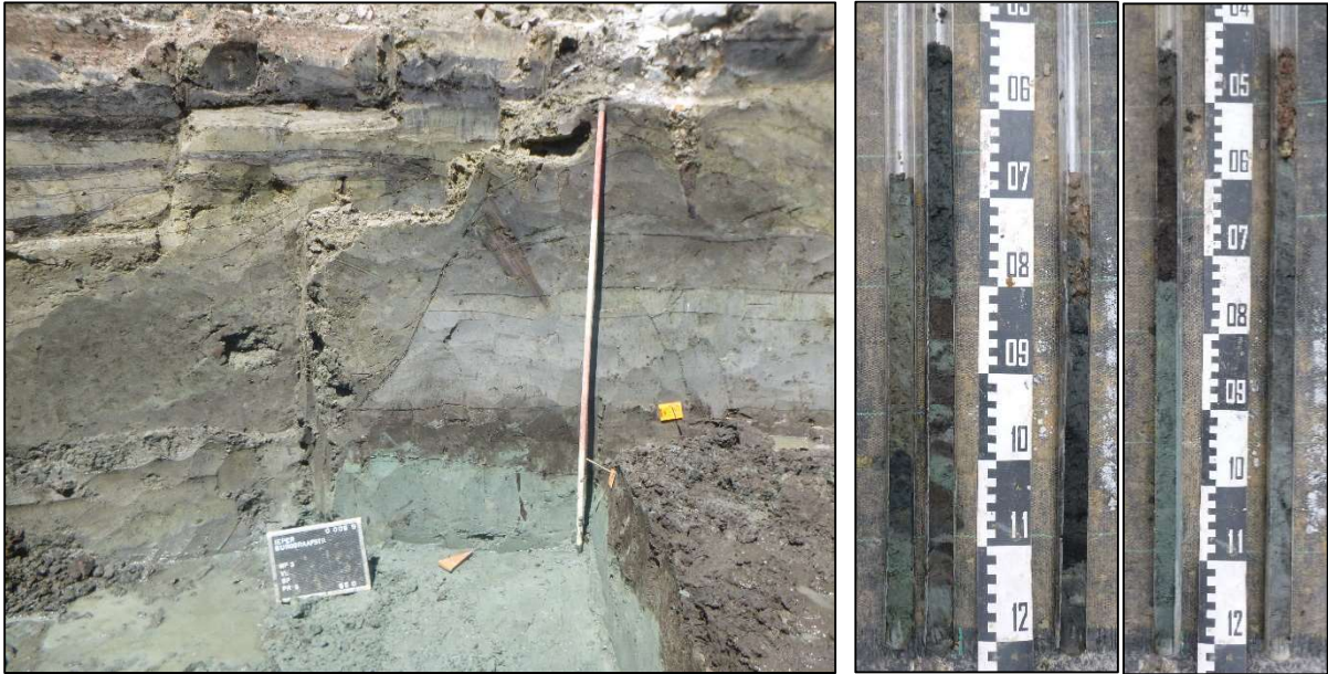
Figuur 8: Overzichtsfoto van profiel 6 (links). Rechts worden boringen BP8 en BP10 weergegeven, uitgelegd van boven naar onder en van rechts naar links.
