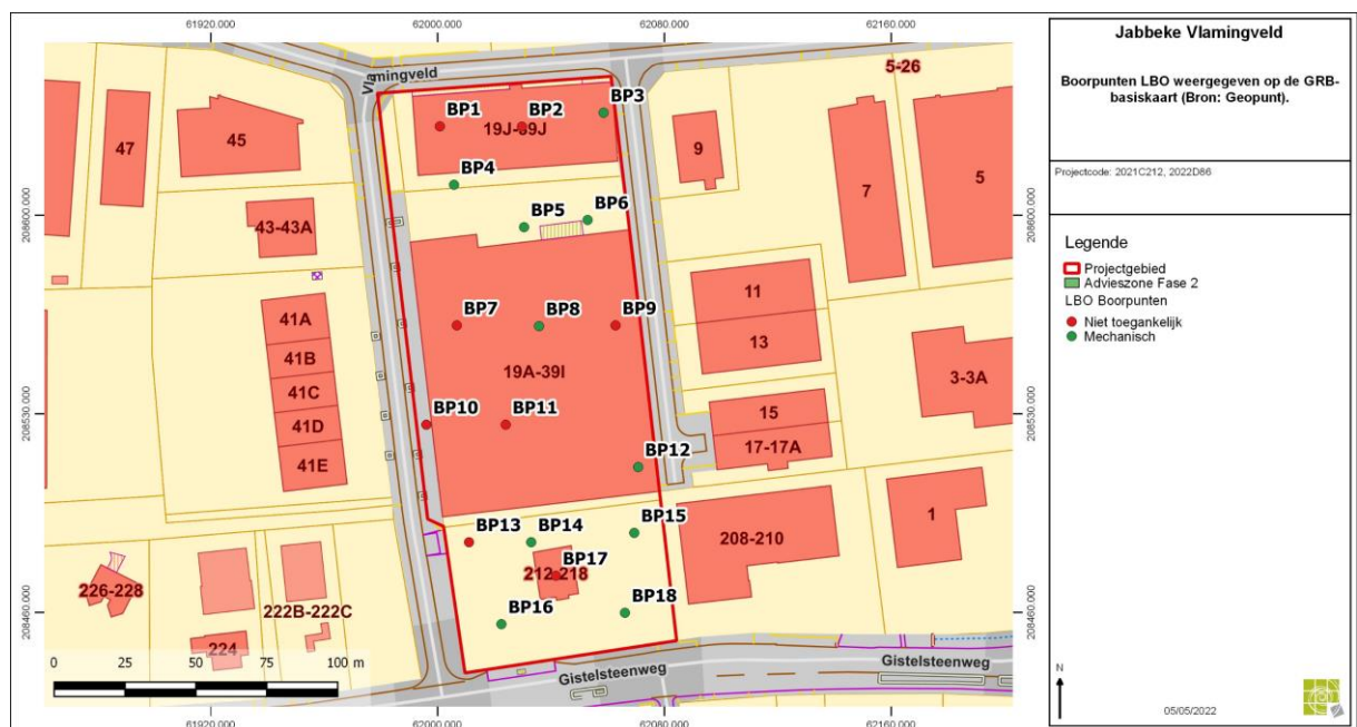
Figuur 3: uitgevoerde boringen.
