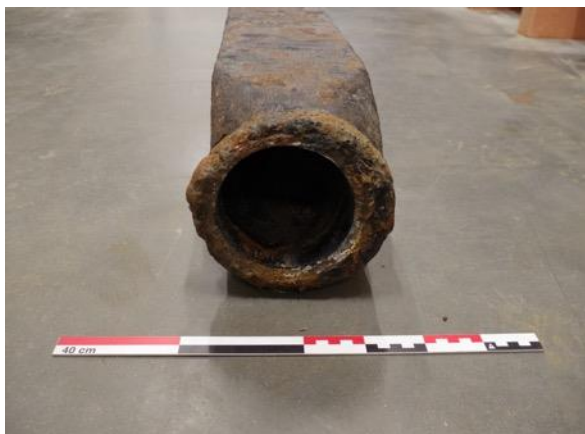
Figuur 16: Links: voorbeeld van een aangepunt uiteinde; rechts: een afgerond uiteinde met ijzeren ring (© agentschap Onroerend Erfgoed).
