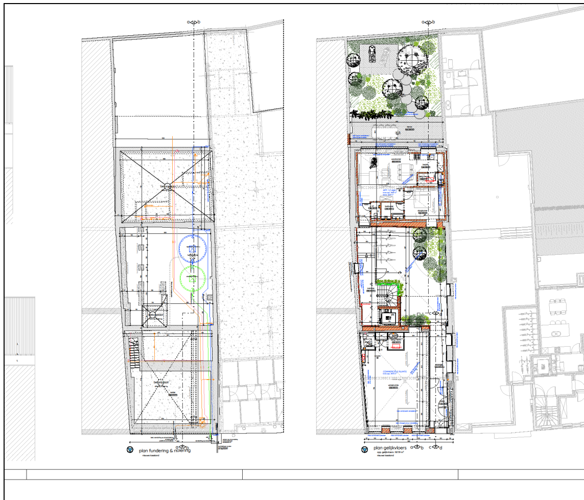
Afb. 3: Detail van ontwerptoestand: Links funderings- rioleringsplan; rechts gelijkvloers (Bron: initiatiefnemer, aanmaakschalen 1/50, 1/100, 1/250, 11/08/2022, 2022K61).
