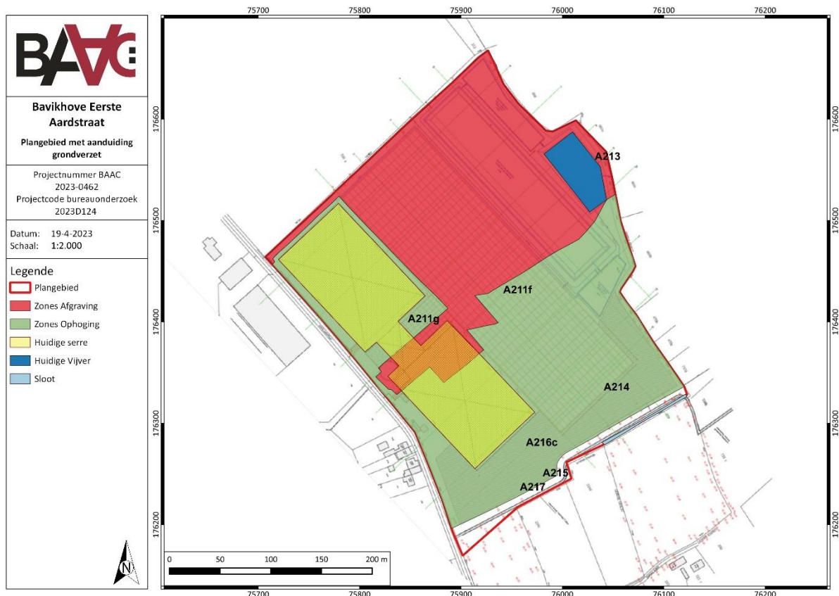
Figuur 2: Plan grondverzet: met rood aangeduid zijn de zones die worden afgegraven en met groen aangeduid zijn de zones die worden opgehoogd. 16
