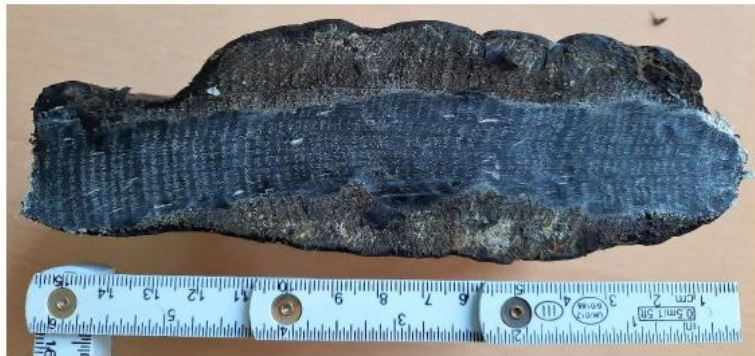
Afb.1 Het jaarringenpatroon van houtmonster V166 zonder spinthout. Het hout is geprepareerd met een dubbelzijdig scheermesje en de houtvaten zijn ingewreven met krijtpoeder.
