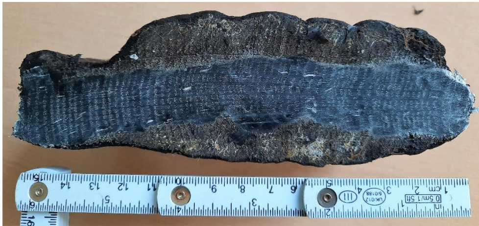
Afb.1 Het jaarringenpatroon van houtmonster V166 zonder spinthout. Het hout is geprepareerd met een dubbelzijdig scheermesje en de houtvaten zijn ingeweven met krijtpoeder.
