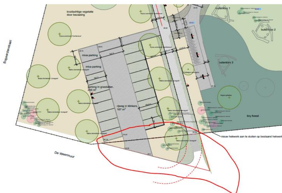
Figuur 15: Weergave van de werken op het inplantingsplan voor desbetreffende zone die niet mee was opgenomen in de advieszone. De werken blijven echter beperkt in diepte en hebben geen impact op archeologisch relevante niveaus.
