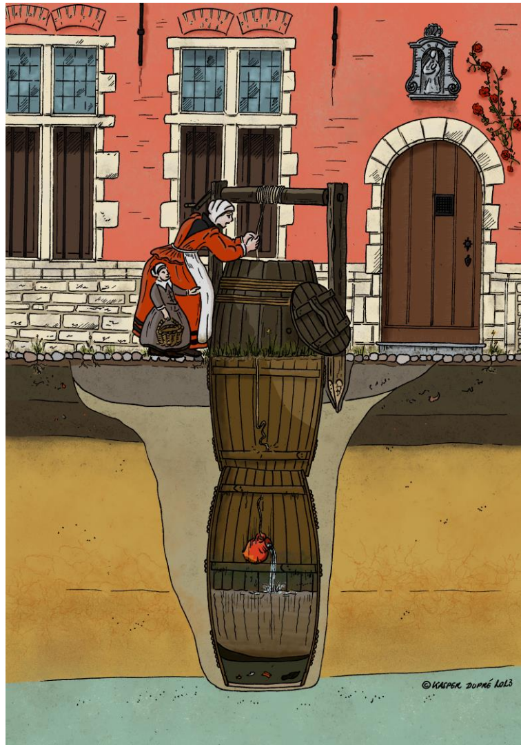
Figuur 228: Didactische tekening van een tonwaterput (© Kasper Dupré)
