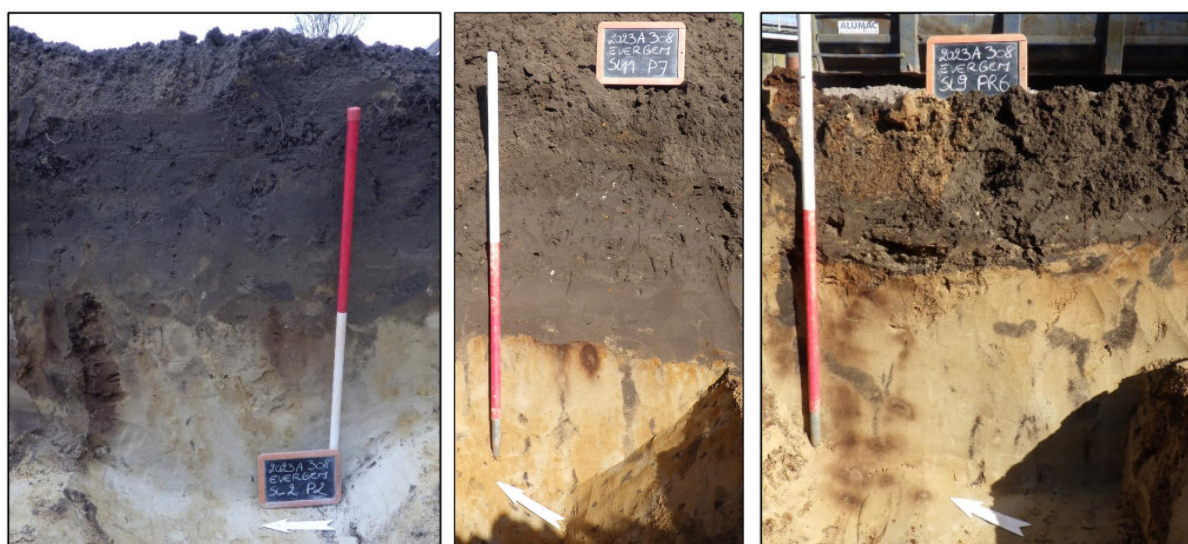
Figuur 3: Profiel 2 met een Ap1-Ap2-B-C opbouw (links), profiel 7 met een Ap1-Ap2-C opbouw (midden) en profiel 6 met een A-C opbouw (rechts) 15
