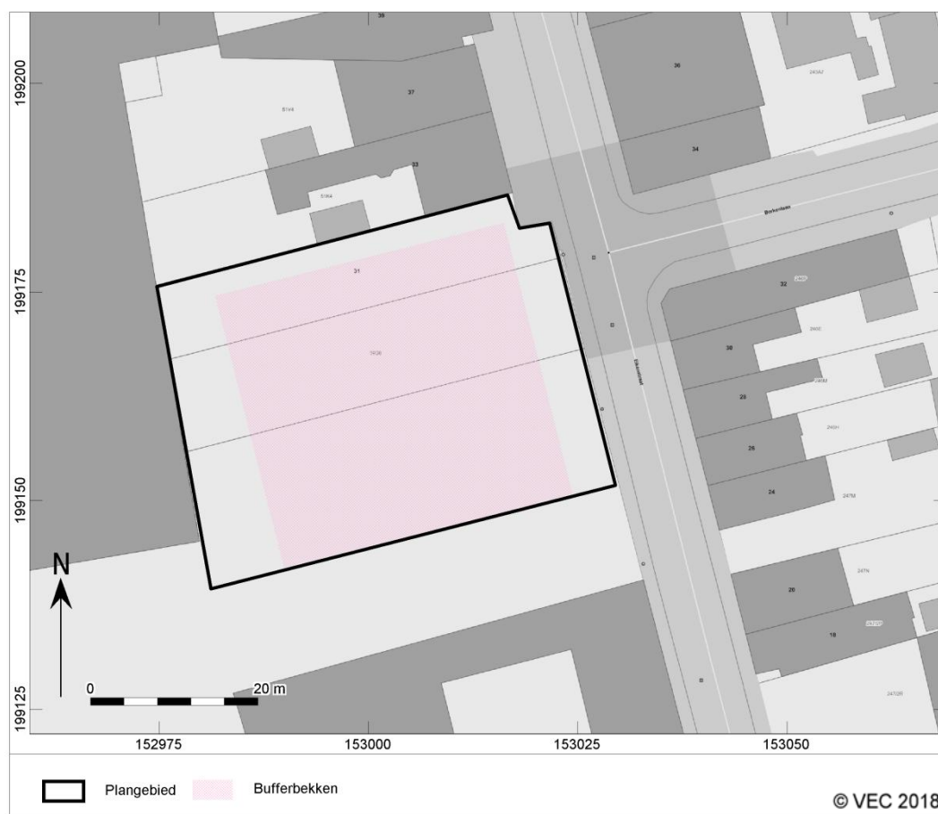
Afb. 1.3. Geplande werken: bufferbekken aangeduid in het roze.
